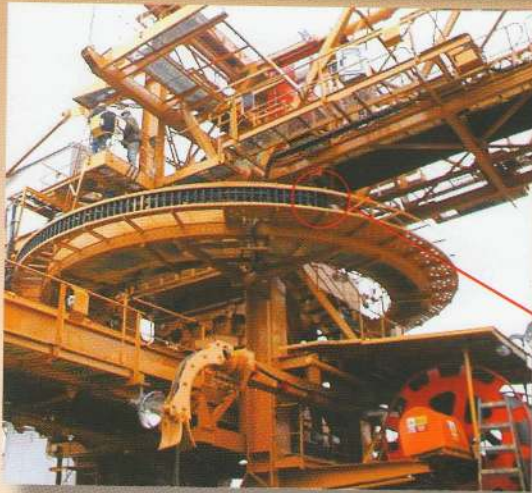
Круговое исполнение может быть как в горизонтальной, так и вертикальной плоскости
